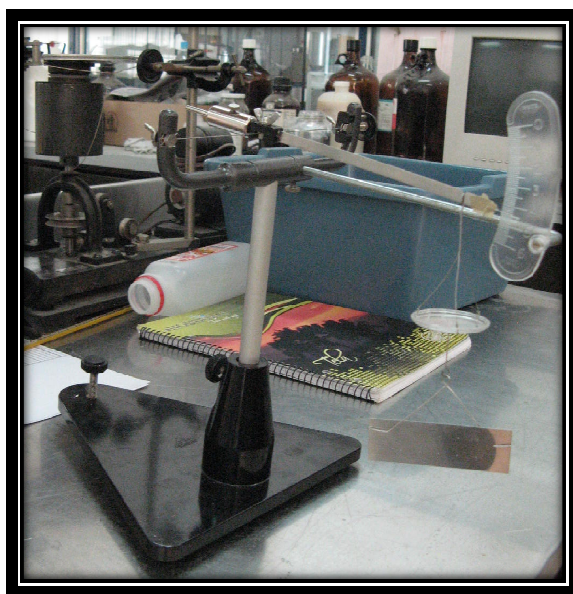
Figura 4.3.2. Detalle de la instalación de balanza para medición de tensión superficial
