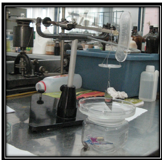
Figura 4.3.3. Secuencia de medición de la tensión superficial con la balanza.
