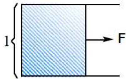
Figura 1.3.2. Definición mecánica de la tensión superficial.
