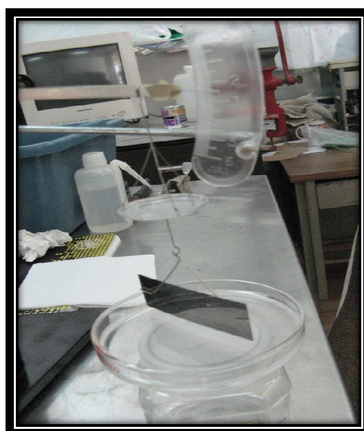
Figura 4.3.3. Secuencia de medición de la tensión superficial con la balanza.
