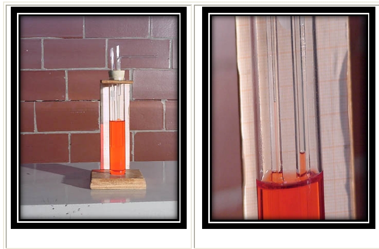
Figura 1.3.12. Equipo para determinar tensión superficial por el método de Ascenso Capilar
