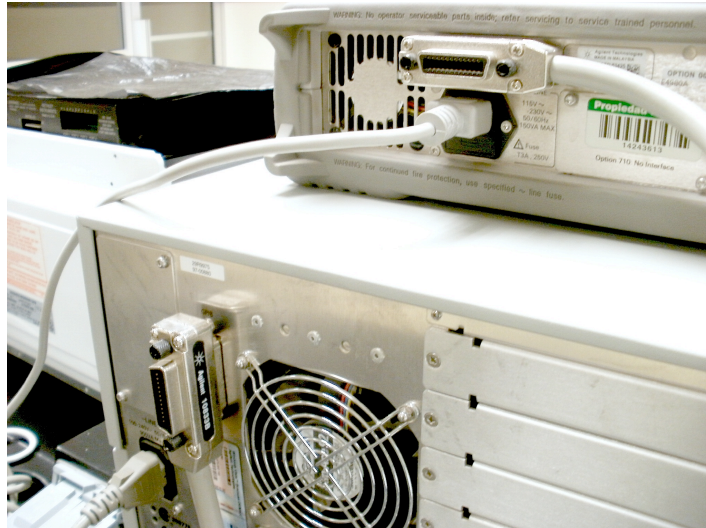
Fig. 13. Conexión entre SDA B1500A y LCR E4980A mediante bus GPIB.
