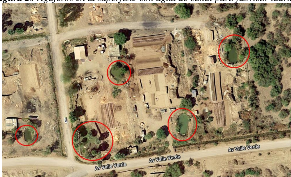
Figura 20 Agujeros en la superficie con agua de canal para fabricar ladrillos
