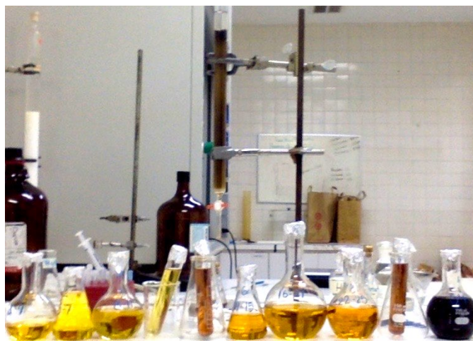
Fig. 17. Recolección de fracciones por el sistema de elución por gradientes de polaridad en columna cromatográfica
