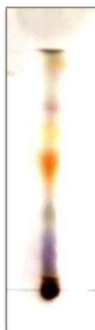
Fig. 15. Revelado de TLC de RSM-A (extracto de raíz fracción acetato de etilo). La mancha color naranja indica la presencia de un compuesto de polaridad media.
