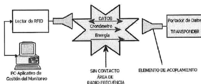
Figura 2 Comunicación Lector – Transponder RFID
