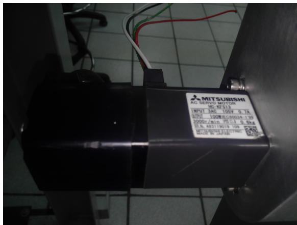
Figura 33. Motor HC-KFS13, actuador de la articulación en el eslabón 2.
