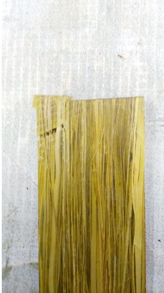
Imagen 18. Fractura en la probeta 2 del tratamiento alcalino (10 min) (80/20).
