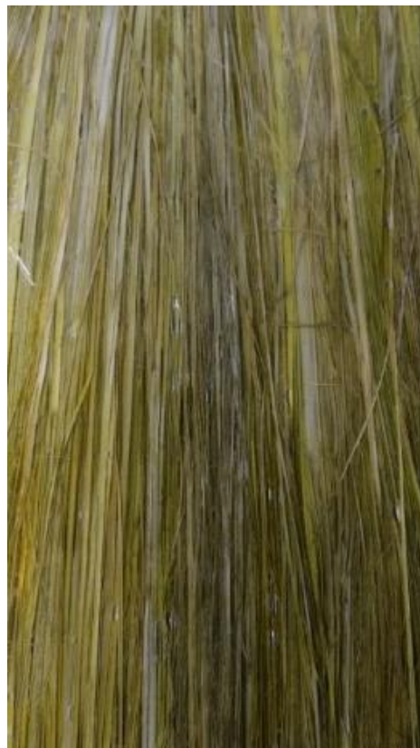
Imagen 7. Muestra de posicionamiento de fibras en laminado (disolución 70/30).
