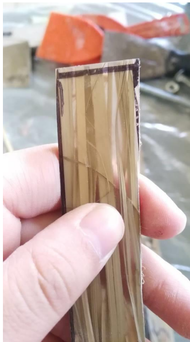
Imagen 15. Fractura en la probeta 2 del tratamiento alcalino (30 min) (70/30).
