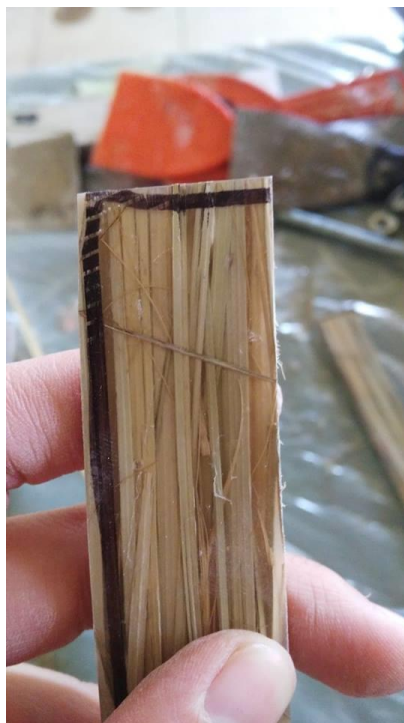
Imagen 17. Fractura en la probeta 1 del tratamiento alcalino (10 min) (70/30).
