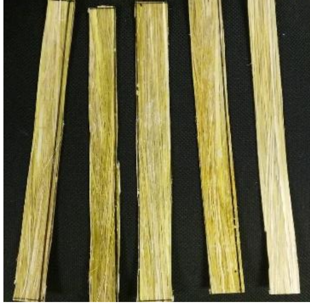
Imagen 14. Corte de las probetas del laminado para la prueba de tensión.
