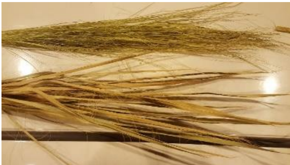
Imagen 3. Fibras de palma antes (abajo) y después (arriba) del proceso de rastrillado.
