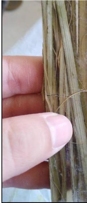
Imagen 16. Fractura en la probeta 3 del tratamiento alcalino (5 min) (70/30).
