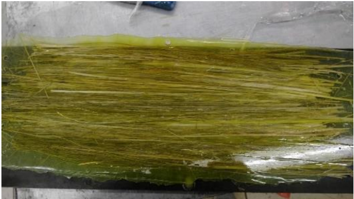
Imagen 8. Laminado de fibras de palma (disolución 70/30).
