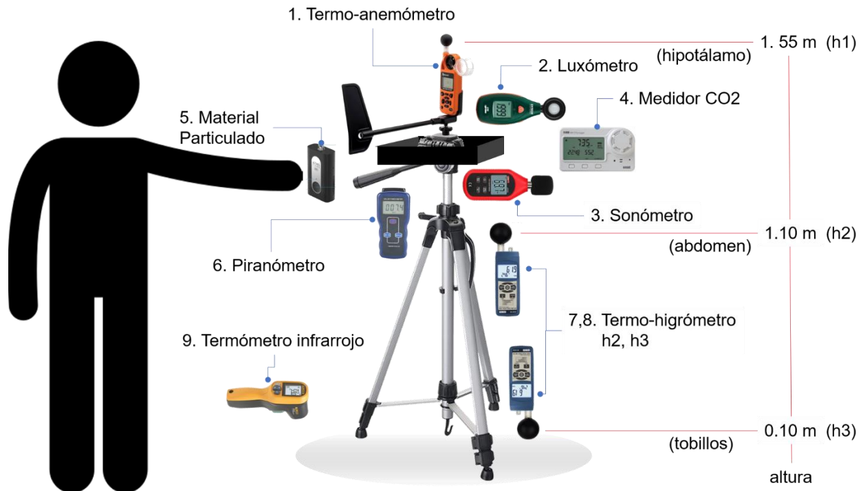
Figura 63. Estación de Registro Ambiental (ERA).
