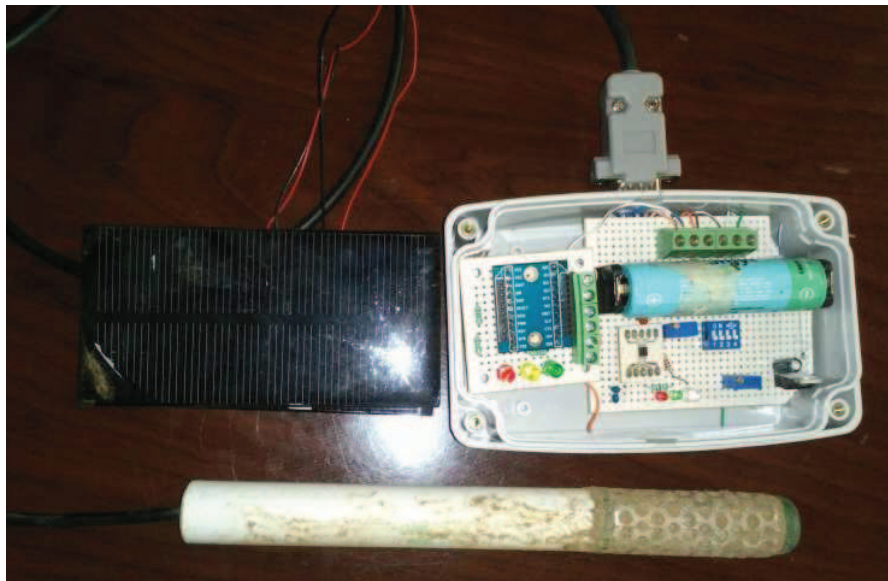
Figura 4.16: Sistema de administración de energía implementado en tarjeta perforada.
