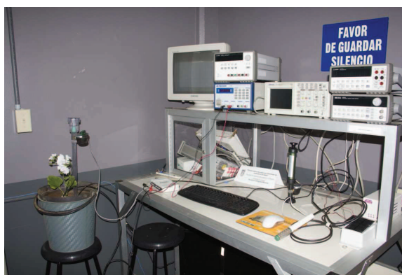
Figura 4.18: Montaje para comparar la respuesta del tensiómetro vs sensor Watermark.
