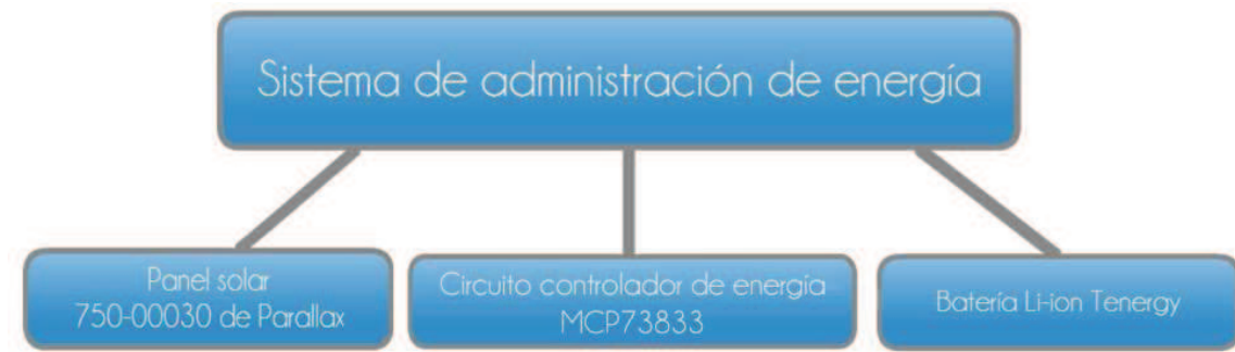
Figura 3.2: Diagrama a bloques del sistema de administración de energía.
