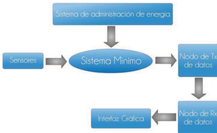
Figura 3.1: Diagrama a bloques del instrumento de medición de la tensión hídrica y temperatura del suelo.
