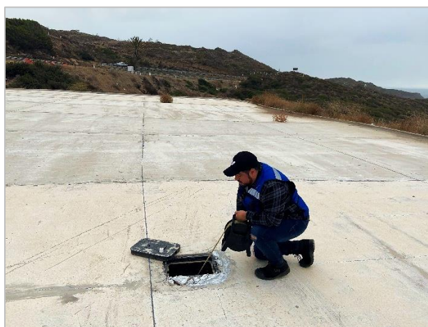
Figura 7.6. Medición del piezómetro 03 del kilómetro 95+000 (cuerpo A, sobre trinchera), durante la quinta visita.
