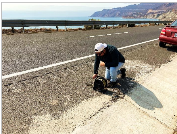
Figura 7.5. Medición del tubo de observación 05 del kilómetro 90+000 (cuerpo B), durante la cuarta visita.
