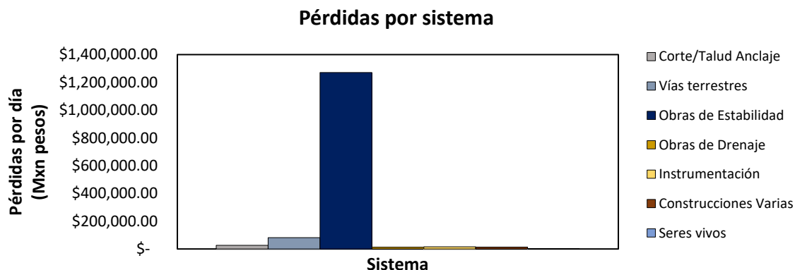
Figura 7.14. Pérdidas por sistema en la Bahía Salsipuedes.
