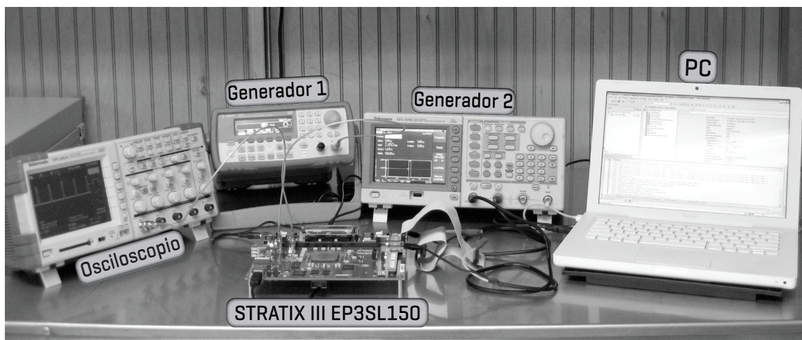
Figura 3.10 Montaje real del prototipo experimental de medición de fase.
