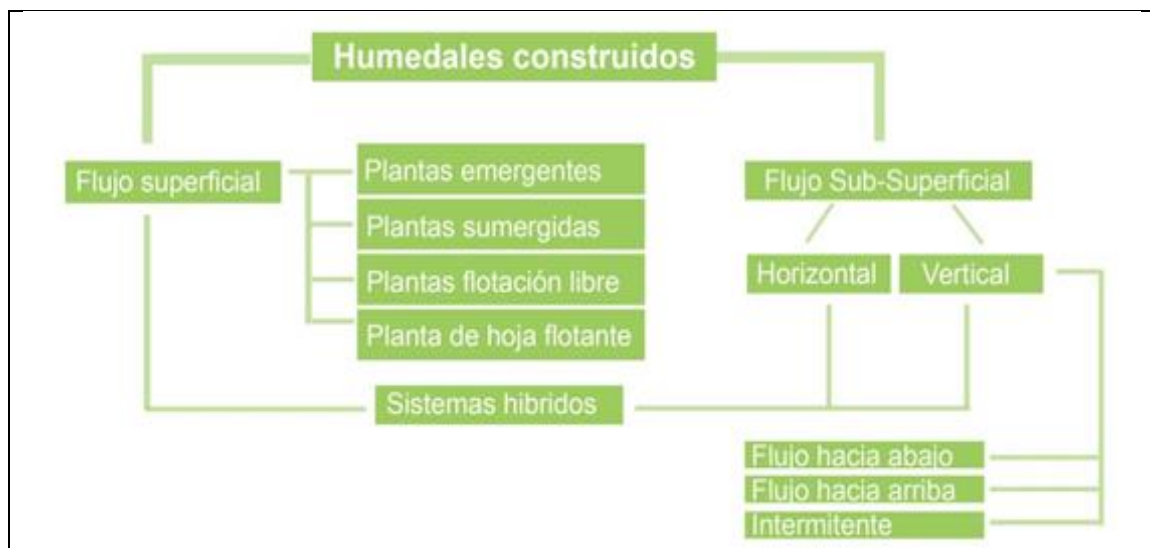
Figura 2.1 Clasificación de humedales construidos (modificado de Vymazal, 2008)
