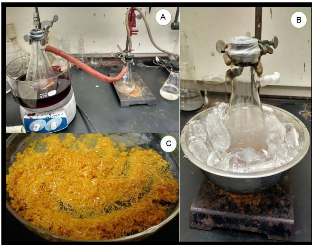
Ilustración 7.- (A) Sistema base para la síntesis del TTA. (B) Baño de hielo para inducir la cristalización. (C) Cristales característicos del TTA.
