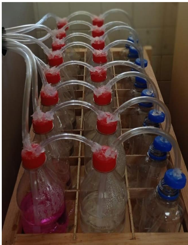
Figura 20. Vista superior del sistema de desplazamiento de agua.
