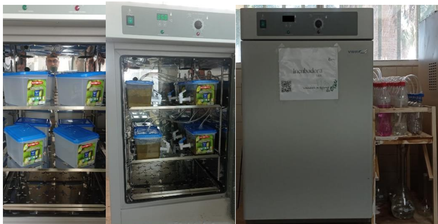
Figura 23. Distribución de biodigestores al interior de la incubadora
