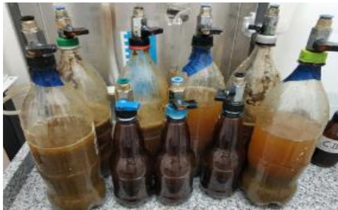
Figura 10. Digestor tipo batch [61].
