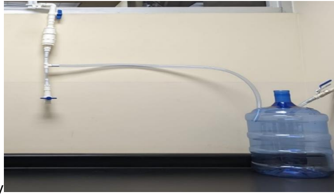
Figura 39. Cartuchos de hierros, purga de agua y depósito de biogás.
