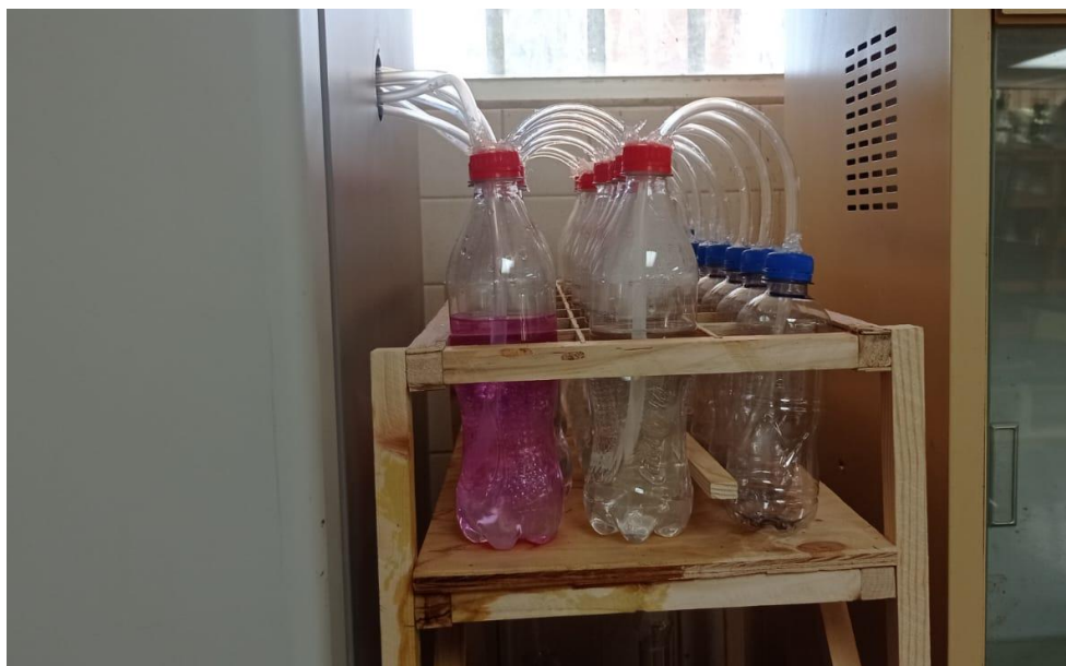
Figura 24. Salida de tuberías que comunican los biodigestores con el sistema de medición de biogás y biometano
