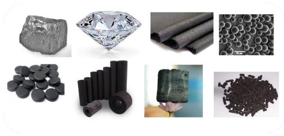
Figura 6. Imágenes de diferentes materiales a base de carbono como el grafito, diamante, fibra de carbono, esferas de carbono, carbón activado, filtros de carbón activado, esponjas de grafeno, filtros de agua de carbón activado (Parra, 2004).
