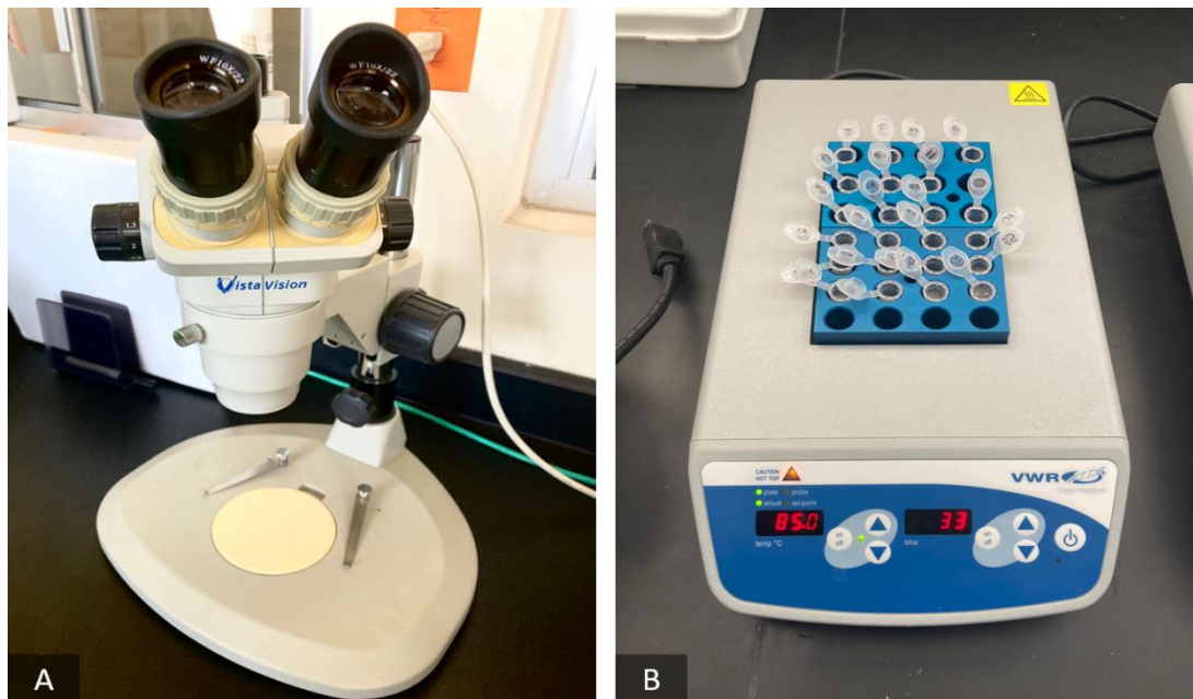
Figura 8. (A) Microscopio Avantor VWR Vistavision para analizar tubos eppendorf, (B) Calentador digital Thermo block utilizado para evaporar el agua destilada a 85°C durante 2-3 hrs.
